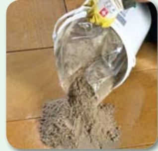
Im Vergleich zu den üblichen luft-sauerstoffhärtenden 1K-Fugenmörteln zeichnet sich **vdw 840 plus FugenMörtel** durch höhere Festigkeit und die Möglichkeit, den Mörtel mittels Wasserstrahl einzuschlämmen, aus.
